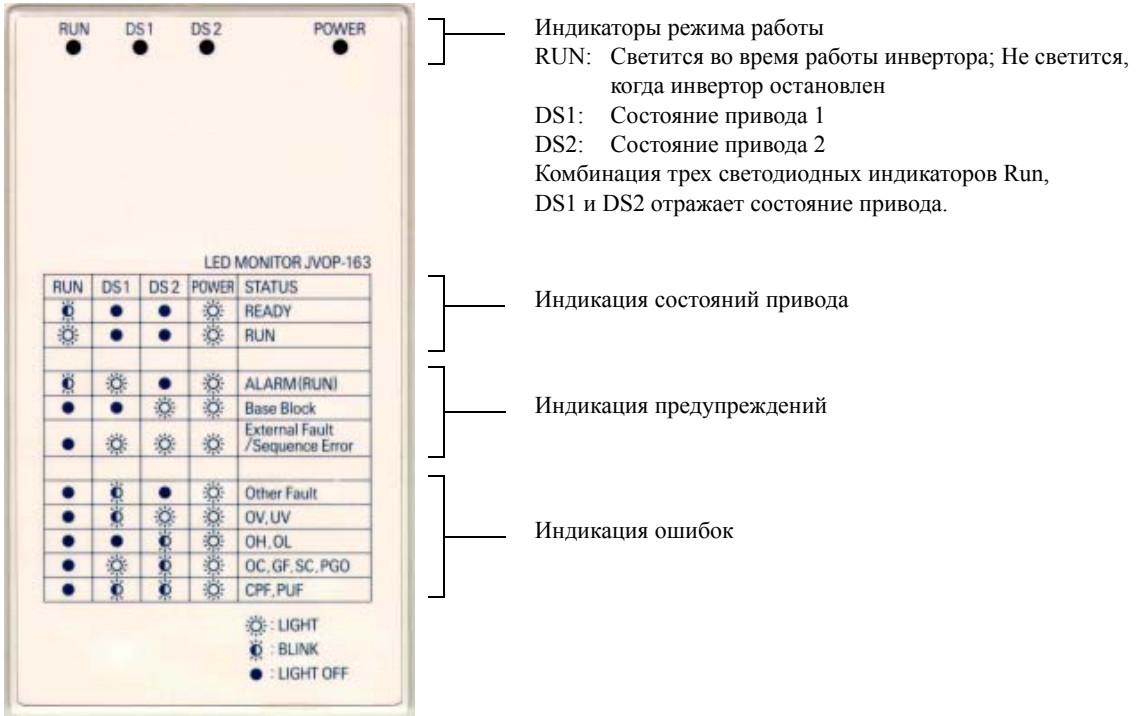
Рис. 3.1 Названия элементов светодиодной панели и выполняемые функции
